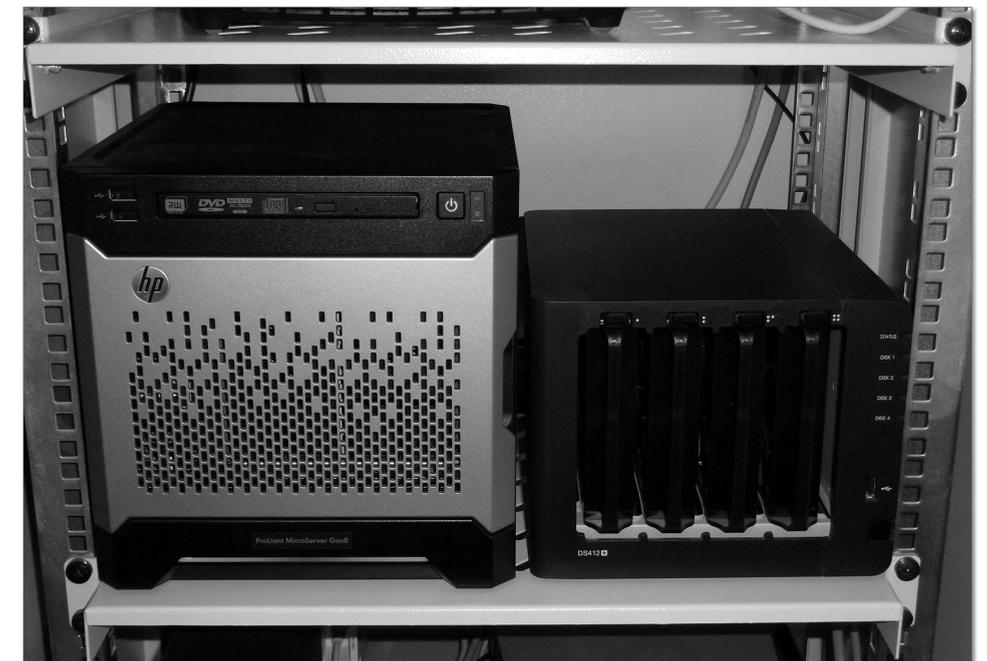
Abbildung 25.5 19-Zoll-Fachböden, auch für schwere Lasten geeignet
